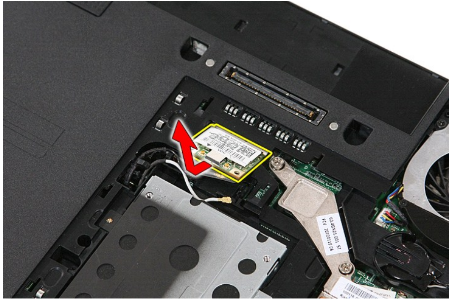
6. قم بإزالة بطاقة WLAN من الكمبيوتر.
