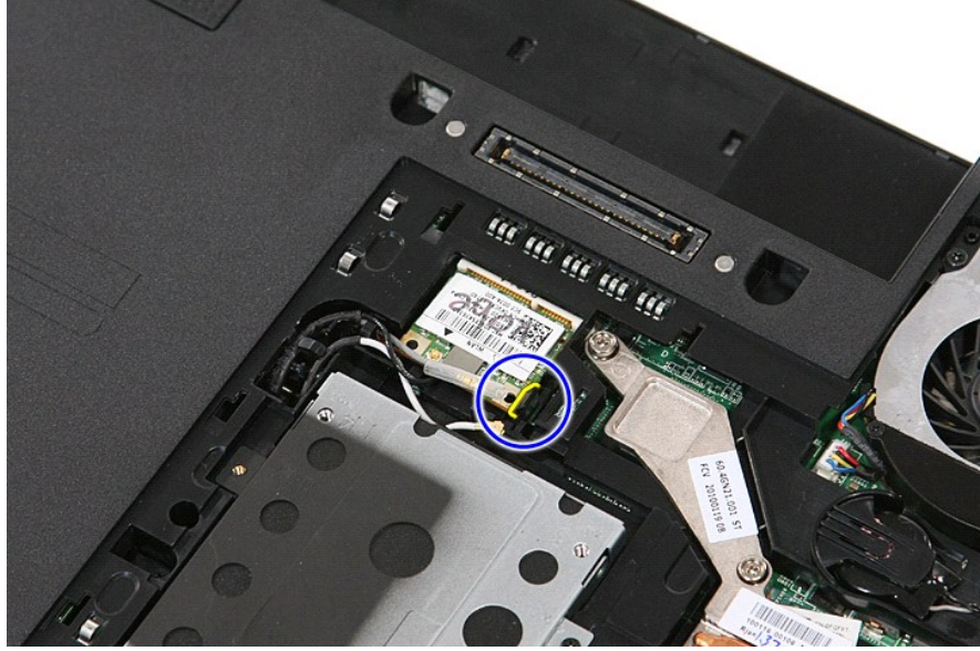
6. قم بإزالة بطاقة WLAN من الكمبيوتر.
